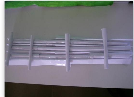
**Pour solidifier le pont, nous mettons des rouleaux en dessous de l'accordéon, nous en avons fait plusieurs.**
